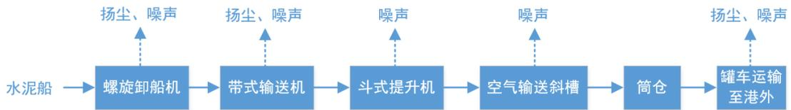
图 4-1 水泥卸船工艺流程图
