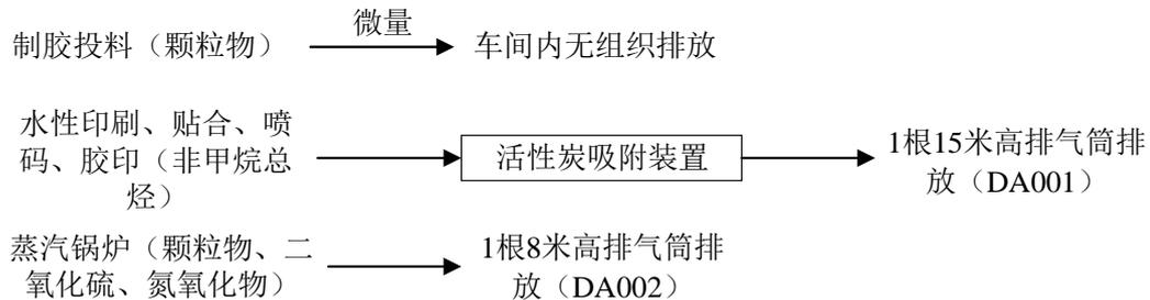
图 4-1 本项目废气收集、处理、排放方式
