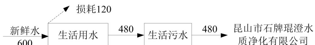
图 2-1 全厂水平衡图 单位：t/a
