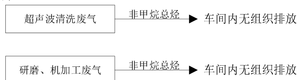
图 4-1 项目废气走向图
