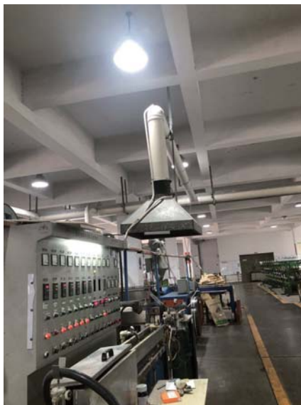
图 4-1 产污工段上方集气罩收集
