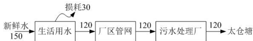
图 2-1 项目水平衡图(单位 t/a)
