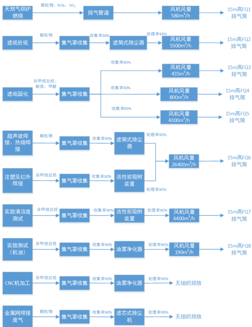
图2-17 现有项目废气处理流程图
