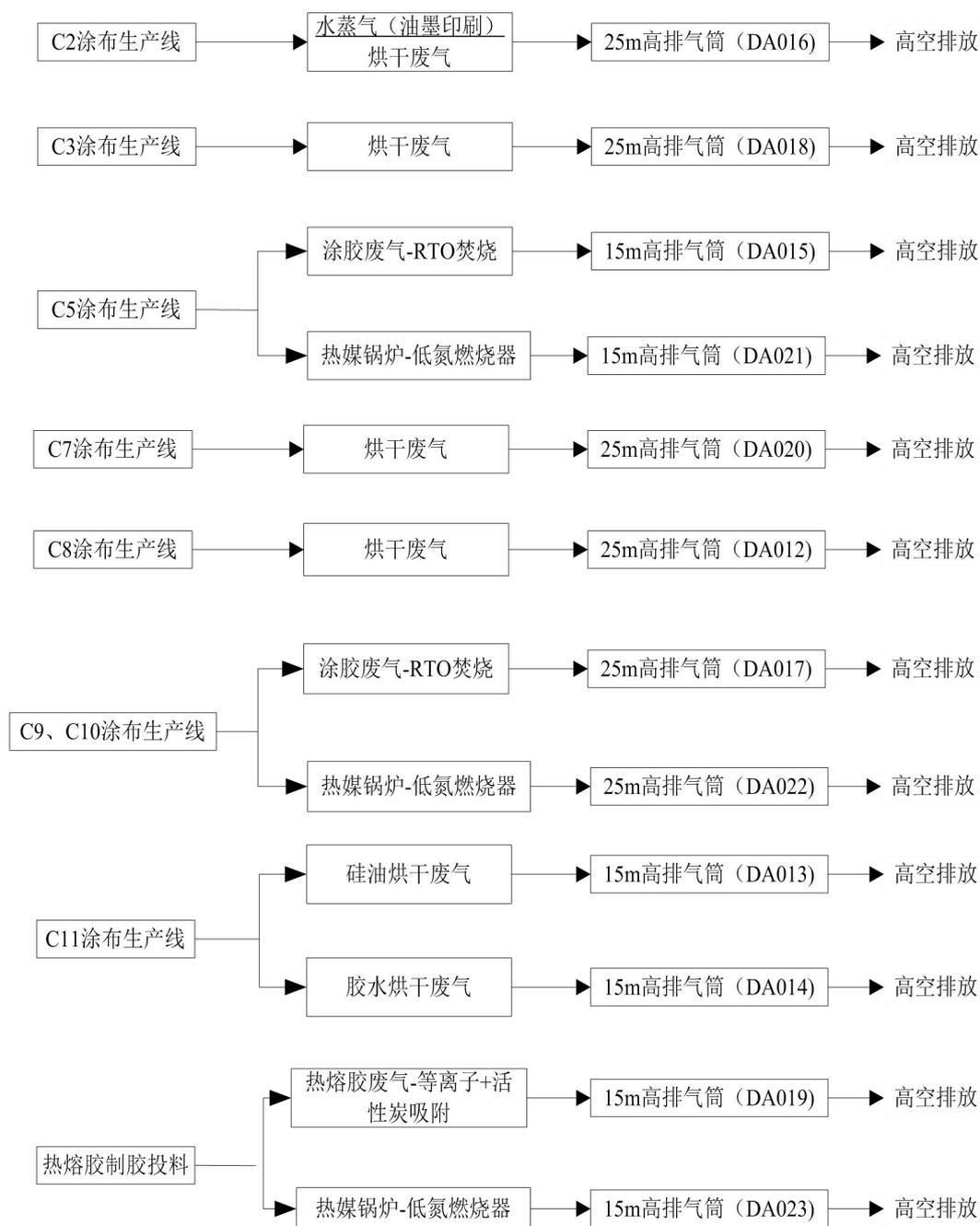
图 2-11 现有项目废气处理工艺流程
