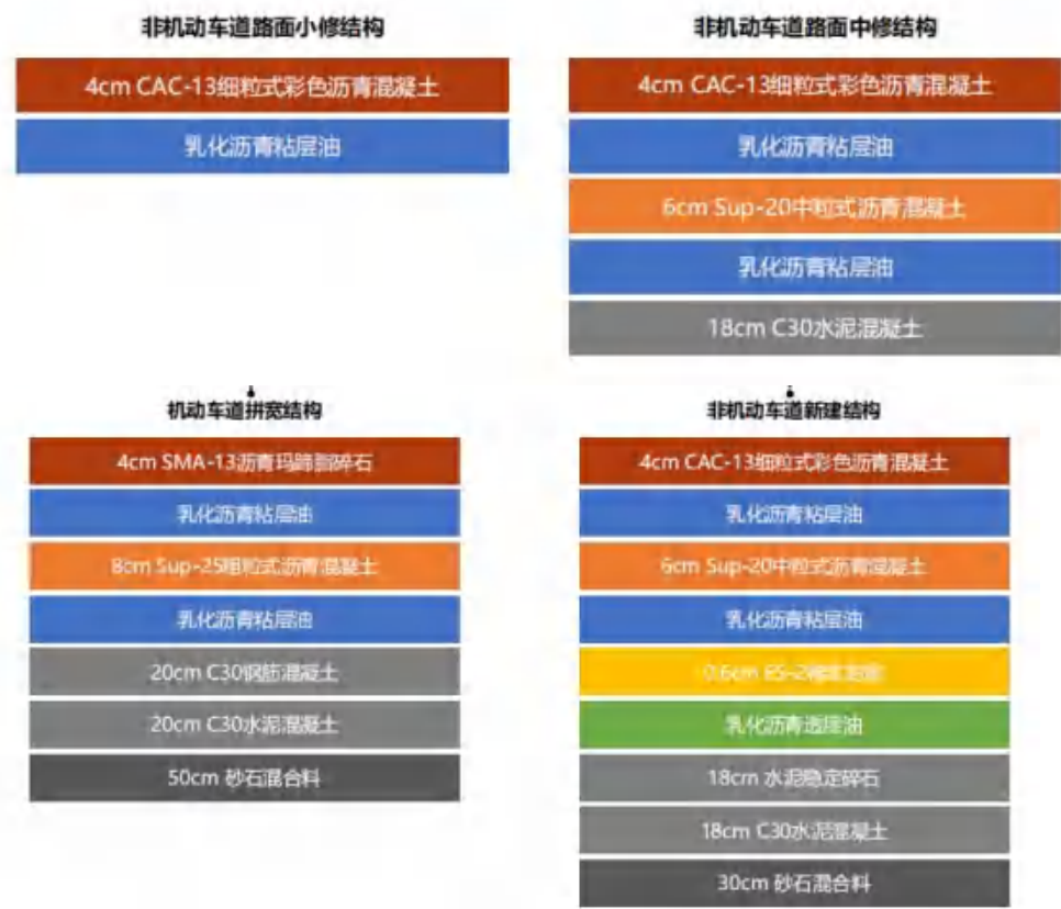
图 2-5 太湖路（南浜路-景王路）设计路基结构图
