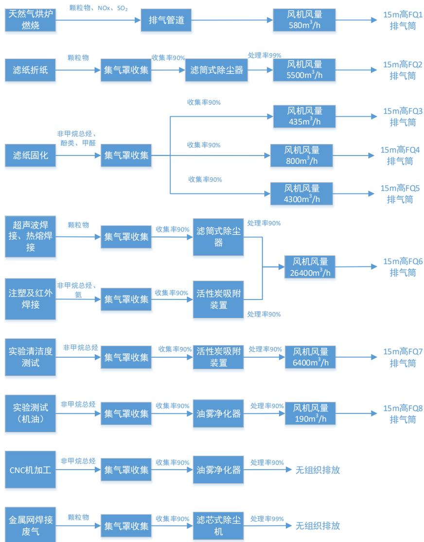
图2-17 现有项目废气处理流程图
