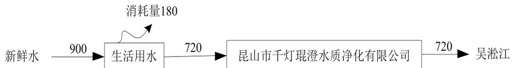
图 2.10-2 水平衡图（单位：t/a）
