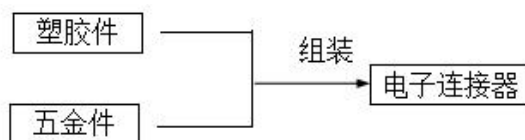
图2-7 电子连接器生产工艺流程图
