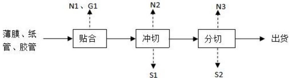
图 5-1 绝缘薄膜生产工艺流程及产污环节图
