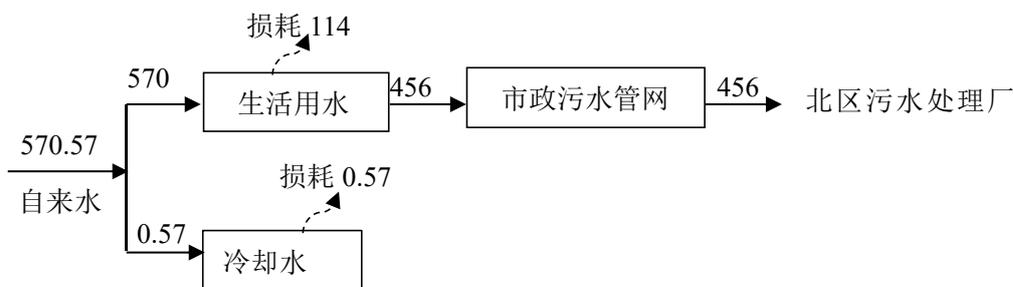
图 5-2 本项目水平衡图（单位：t/a）
