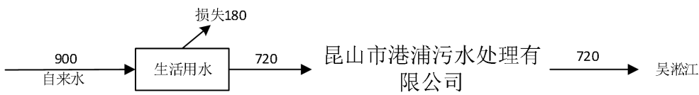
图 2-3 建设项目用排水平衡图（单位 t/a）
