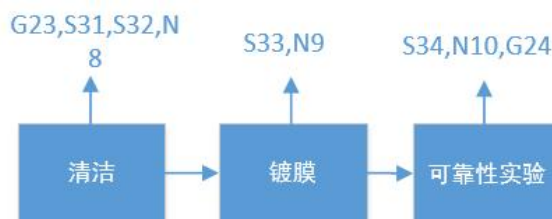
图 2-18 实验室实验样品生产工艺流程图
