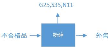
图 2-19 不合格品粉碎工艺流程图
