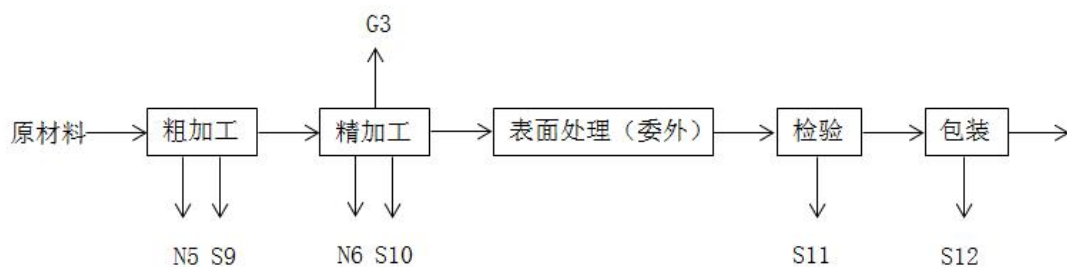
图2-7机加工件生产工艺流程图
