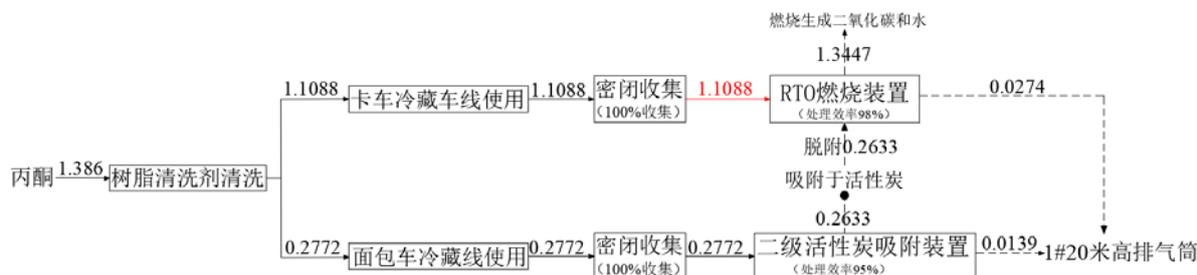
图 5-11 丙酮物料平衡图 (单位: t/a)
