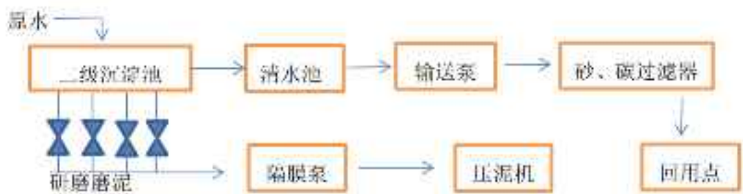
图 2-4 研磨废水循环水设备处理工艺
