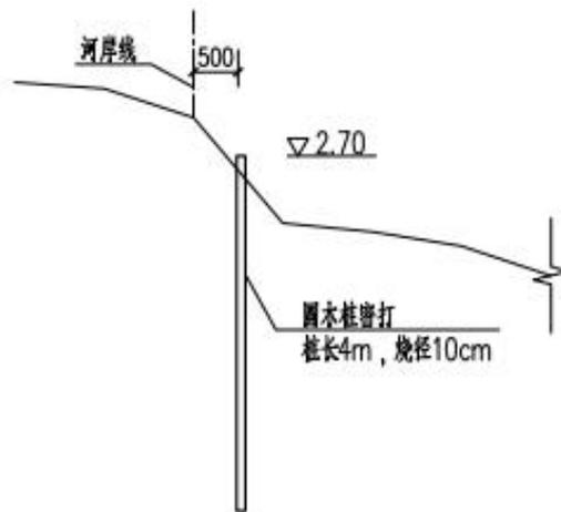
B型挡墙(圆木桩护岸)断面图 1:100
