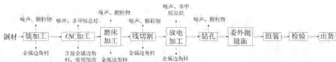
图 2-3 模具工艺流程及产污环节图
