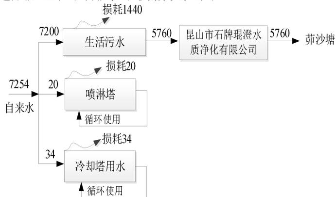
图2-2 扩建项目建成后全厂用排水平衡图 (单位: t/a)
