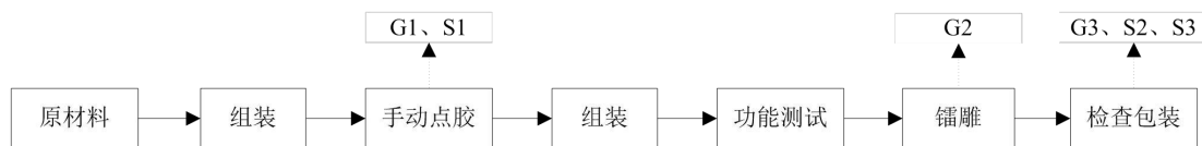
图 2-5 智能音响生产工艺流程图
