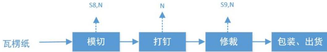
图2-4 原有项目纸箱生产工艺流程图
