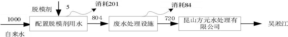
图 2-1 技改项目水平衡图 (单位: t/a)
