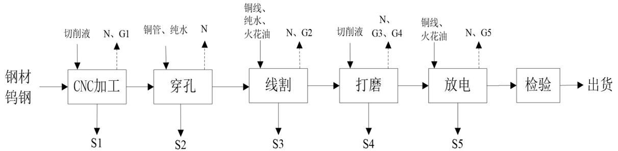
图 5-1 生产工艺流程及产污环节
