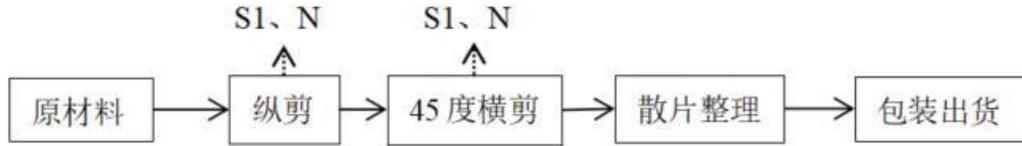
图 2-5 工艺流程及产污环节图
