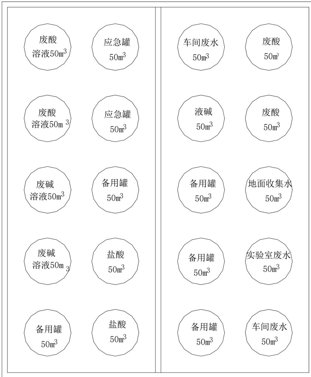
图 4.3-2 2#储罐区平面布置图
