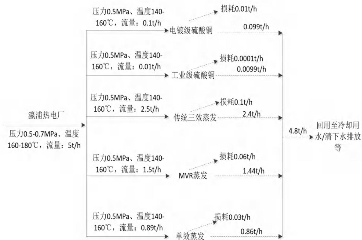
图 4.7-1 技改后全厂蒸气平衡图
